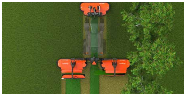
Utilizzo di un tappeto per allontanare il raccolto dai confini del campo.
