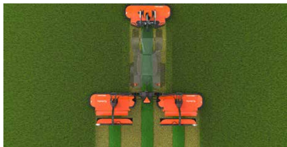
Tre andane singole, facilmente impostabili con i deflettori d'andana regolabili.
