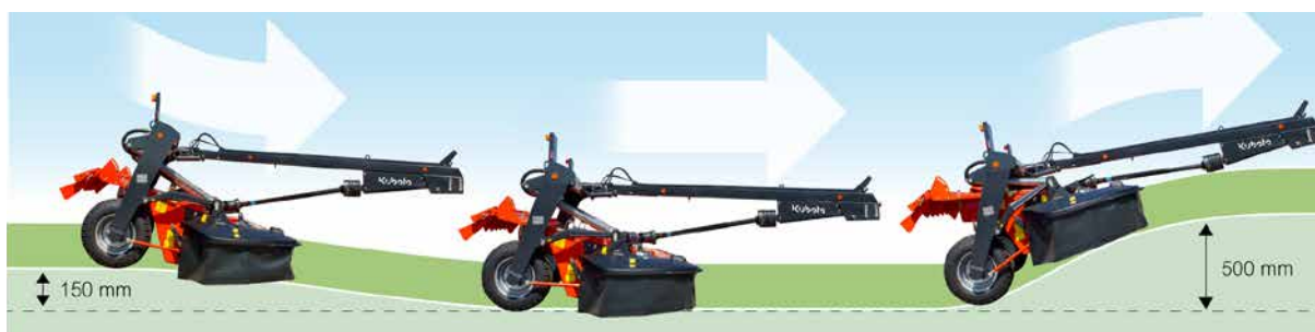
Regolazione idraulica opzionale dell'altezza di taglio per una facile regolazione dalla cabina del trattore.
