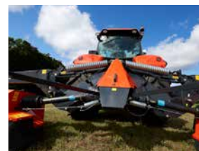
Le molle di sospensione maggiorate assicurano una pressione costante al terreno.
