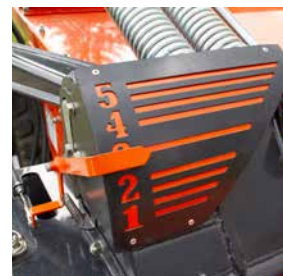
Regolazione idraulica opzionale dell'altezza di taglio per una facile regolazione dalla cabina del trattore.
