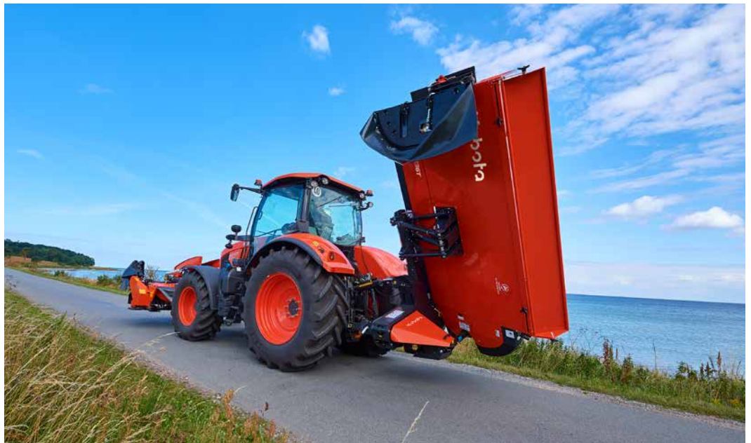
DMC6336T Vario in fase di trasporto. Il braccio telescopico del telaio si abbassa nella posizione più bassa possibile per raggiungere un'altezza di trasporto di soli 3,70 m.
